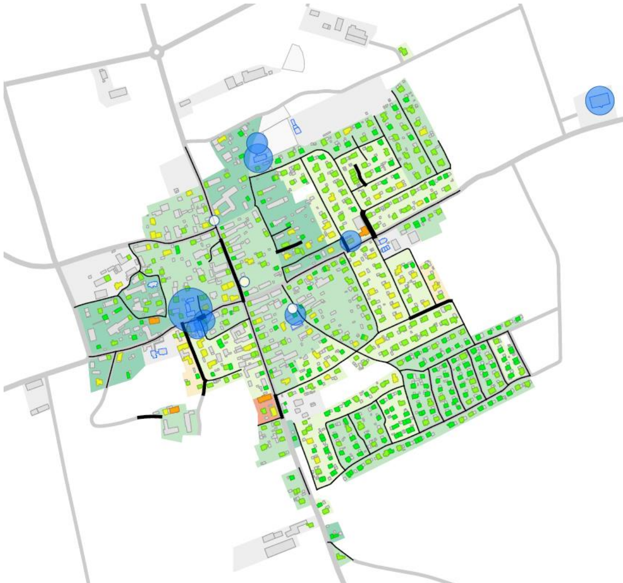
Abbildung 39: Detailansicht Wärmekataster: Ausschnittsweise Darstellung des Wärmebedarfs der Liegenschaften (blaue Kreise, nach Größe unterschieden), des Wohnwärmebedarfs (von grün=niedrig bis rot=hoch), des Wohnwärmebedarfs in Siedlungsflächen (grau=keine Angabe; von grün=niedrig bis orange=hoch) und der Wärmebelegungsdichte an Straßen (schwarze Linien, nach Strichstärke unterschieden) Gemeindegrenzen (rosa Linien)
